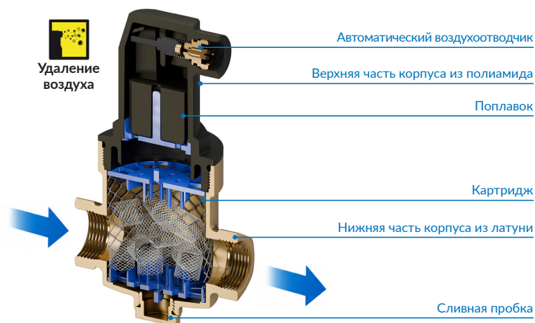
Рис. 1. Конструкция сепаратора воздуха AAS
