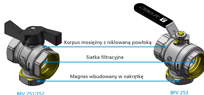
Rys. 2. Budowa zaworu kulowego BFV
