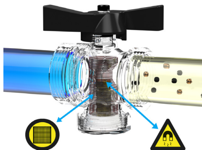
Rys. 1. Zasada działania zaworu kulowego BFV
