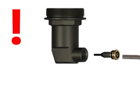
Rys. 11. Montaż śruby odpowietrznika
