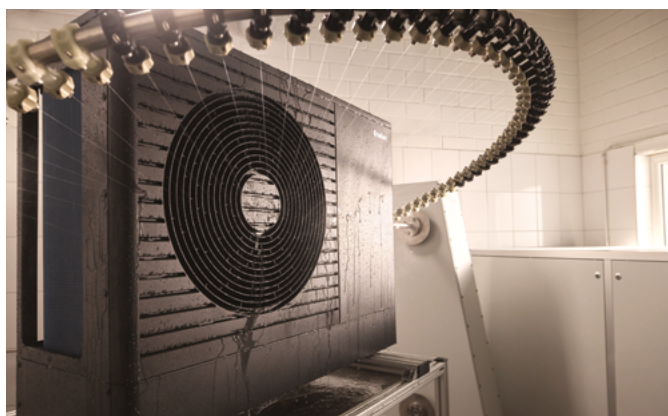
Test rozprysków sprawdzający odporność na gwałtowne ulewy
