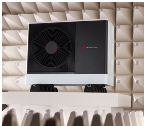
Badania EMC wykluczają emisję zaburzeń elektromagnetycznych w trakcie pracy
