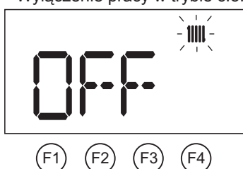
Rys.5 Wyłączenie pracy w trybie c.o.
