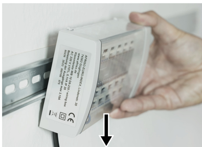
Figure 9: Détacher le produit du rail DIN
